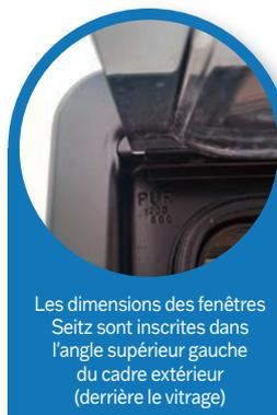
Les dimensions des fenêtres Seitz sont inscrites dans l'angle supérieur gauche du cadre extérieur (derrière le vitrage)
